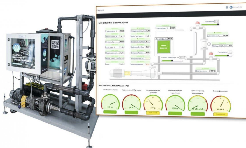
Рис. 1. Пример цифрового двойника: насосная установка
