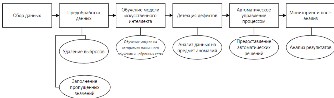
Рис. 1. Схема обнаружения дефектов с помощью ИИ
