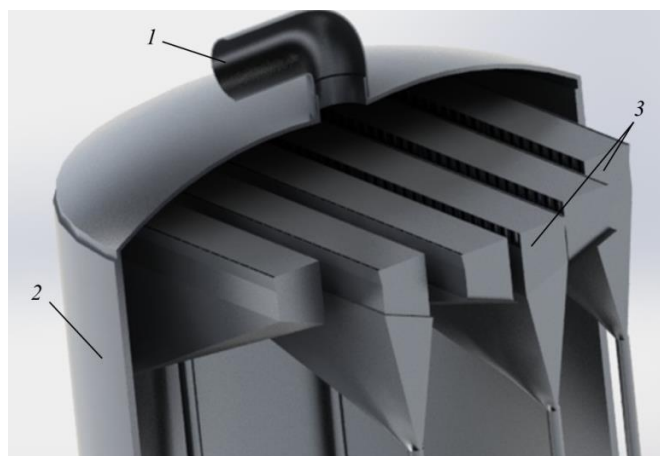
Рис. 1. Упрощенная модель реактора с псевдооживленным слоем: 1 – входной патрубок реактора, 2 – корпус, 3 – сепарационные устройства с дугообразными элементами
