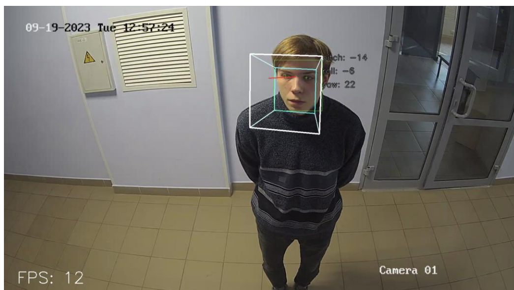
Рис. 5. Пример работы алгоритма по аппроксимации направления взгляда человека
